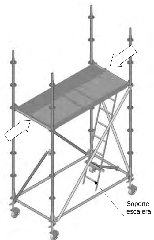
Figura 5b. Plataformas sobre largueros situados a 2 m de altura con respecto los iniciadores. Descanso de escalera sobre soporte escalera.
